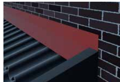
Nokplaat tegen muur- Bevestigingsdetail
